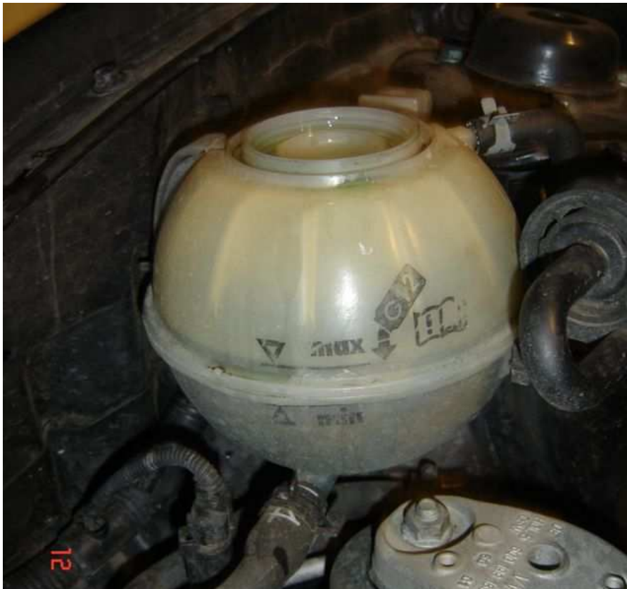
Vaschetta di espansione, con in evidenza i livelli MAX e MIN. La sigla G12 si riferisce la tipo di liquido da utilizzare.
